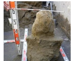
写真 3-2 改良体②全景
