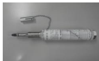
図 2.2 携帯型針貫入試験機
