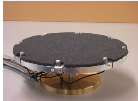
図 1. 8ch マイクロホンアレイによる音源分離
